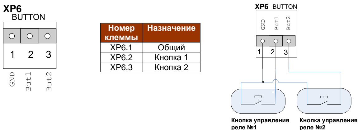
рис. 15. Разъем XP6 (BUTTON) с примером подключения кнопок управления реле
