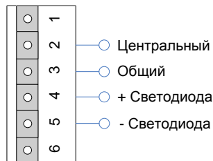
рис. 17. Схема подключения считывателей типа «1-Wire» к клеммам XP2 и/или XP3
