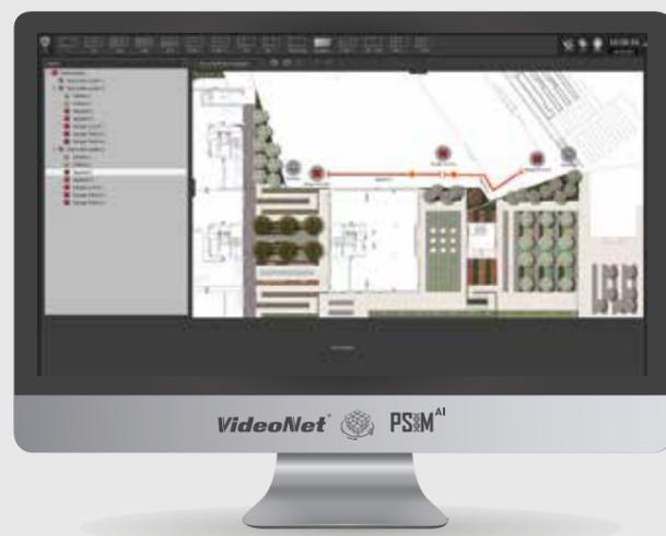
Для удобной работы и оперативного реагирования службы безопасности все устройства размещают на графических планах. VideoNet позволяет управлять устройствами охраны периметра непосредственно из окна графических планов: ставить на охрану и снимать с охраны сегменты и датчики периметра, получать информацию о состоянии размещенных по периметру устройств (тревога на сегменте, тревога по датчику, взлом и т.д.)
